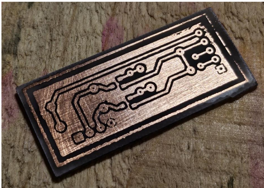
Obrázek 75 - Plošný spoj po vyleptání chloridem železitým a očištění
