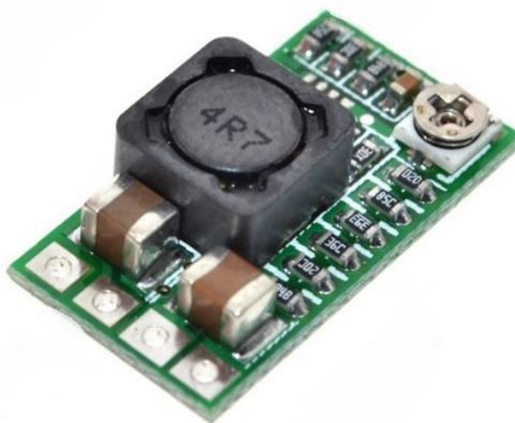
Obrázek 40 - Použitý step-down měnič. Mikro step-down měnič, nastavitelný . Online. In: LáskaKit. C2025. Dostupné z: https://www.laskakit.cz/mikro-step-down-menic--nastavitelny/ . [cit. 2025-03-05].
