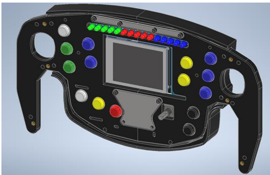
Obrázek 30 - CAD model volantu s výztuhou
