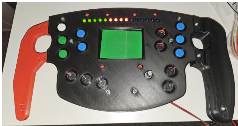
Obrázek 77 - Prototyp volantu s testovacím firmwarem
