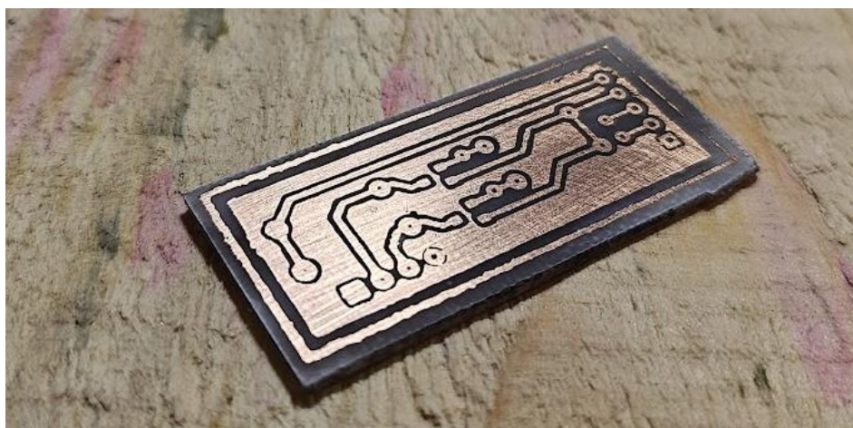
Obrázek 24 - Jednoduchý plošný spoj vyrobený metodou přenosu toneru
