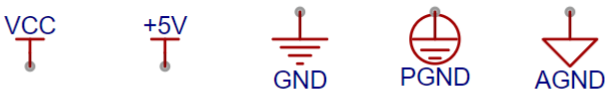
Obrázek 5 – Vlajky (Net flags) v softwaru EasyEDA
