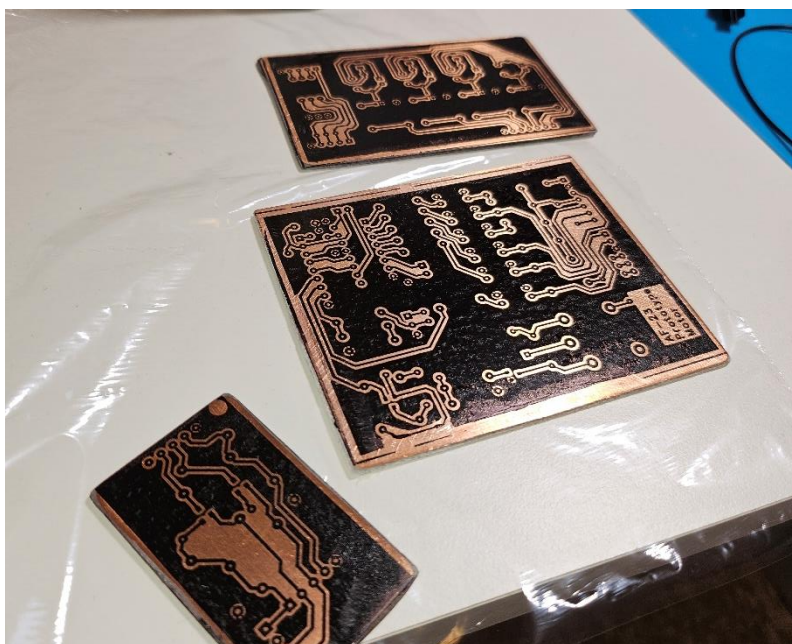
Obrázek 25 - Desky cuprexitu s nažehlenými pozitivy
